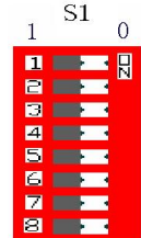
图 3-2 设置地址的拨码开关 S1
