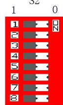
图 3-1 设置波特率的拨码开关 S2
